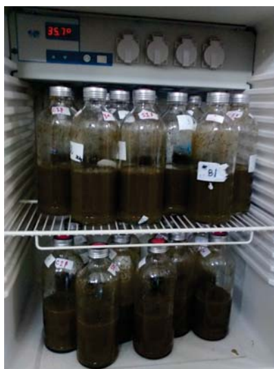
FIGURE 4.2.3 – Batches placés en étuve à 37 °C
