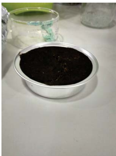
FIGURE 4.2.2 – Détermination du taux de matière sèche
