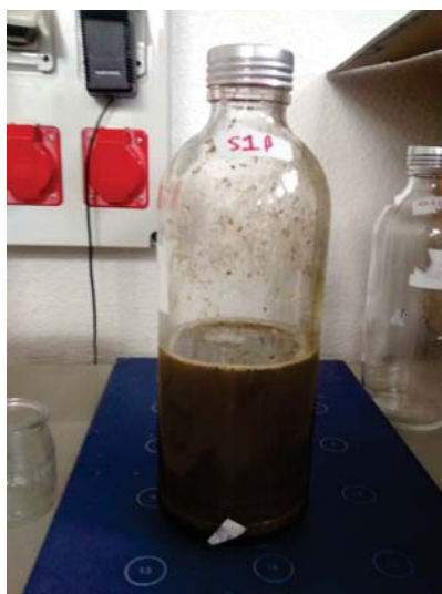
FIGURE 4.2.1 – Milieu réactionnel de méthanisation en batch
