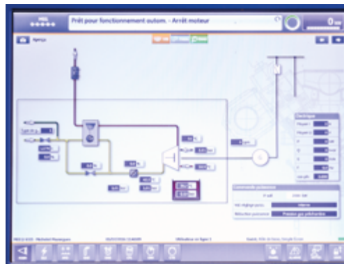
Pilotage et centralisation des données (écran de supervision)
